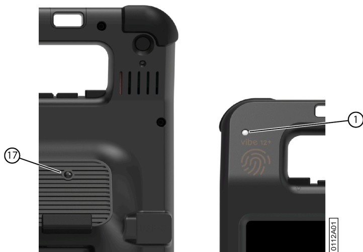
Figur 13. Den infraröda sändaren och den infraröda mottagaren
