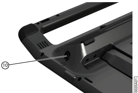
Figur 5. Anslutning för att ladda samtalsapparaten
